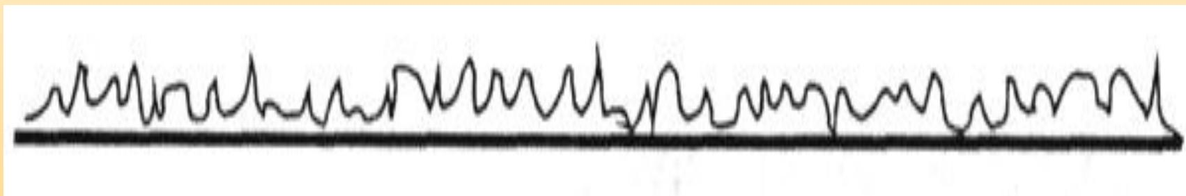
В электрофоне колебания движущейся по звуковой дорожке иглы превращаются в непрерывный электрический сигнал. Электрический сигнал передается на динамик электрофона и превращается в звук.
