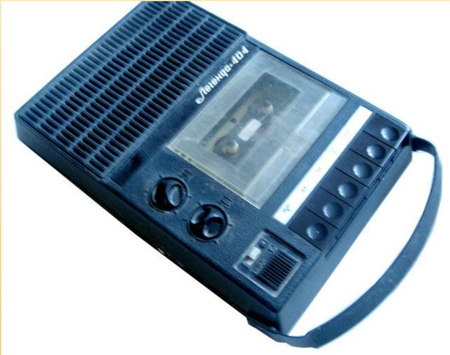
С помощью считывающей магнитной головки создается переменный электрический сигнал, который озвучивается акустической системой.
