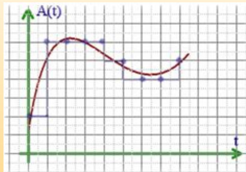
В процессе кодирования звукового сигнала производится его временная дискретизация – непрерывная волна разбивается на отдельные маленькие временные участки и для каждого такого участка устанавливается определенная величина амплитуды.
