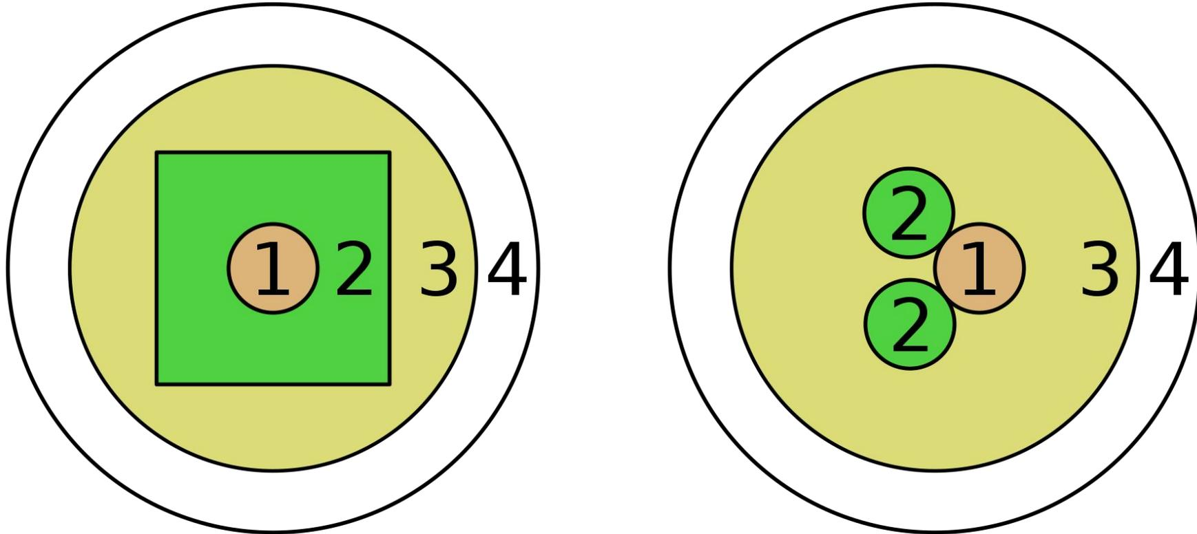
Слева: схема волокна с двойным покрытием. Справа: Схема GTWave с двумя(для примера) волноводами накачки
