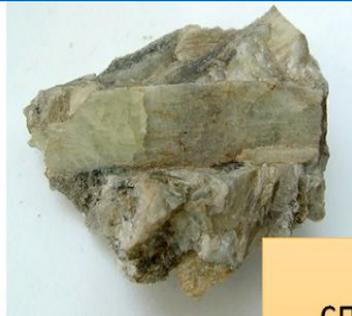
сподумен  $\text{Li}_2\text{O} \cdot \text{Al}_2\text{O}_3 \cdot 4\text{SiO}_2$
