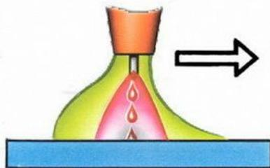
При чрезмерной скорости сварки могут окислиться конец проволоки и металл шва.
