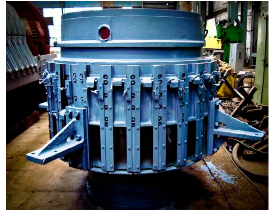
Схема и внешний вид центробежной свеклорезки
