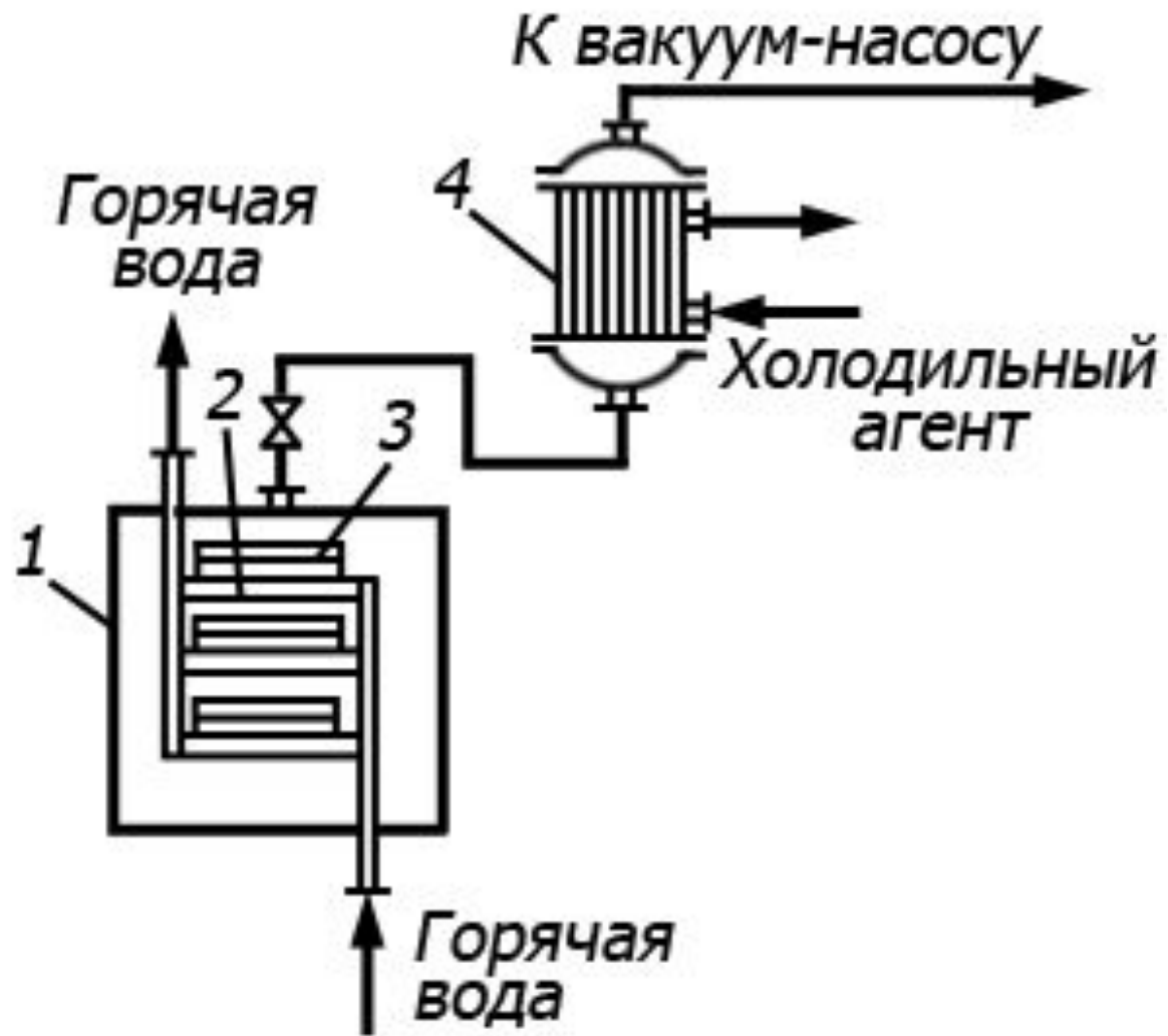
Установка сублимационной сушки: 1 – сублиматор; 2 – плиты; 3 – противни; 4 – вымораживатель.
