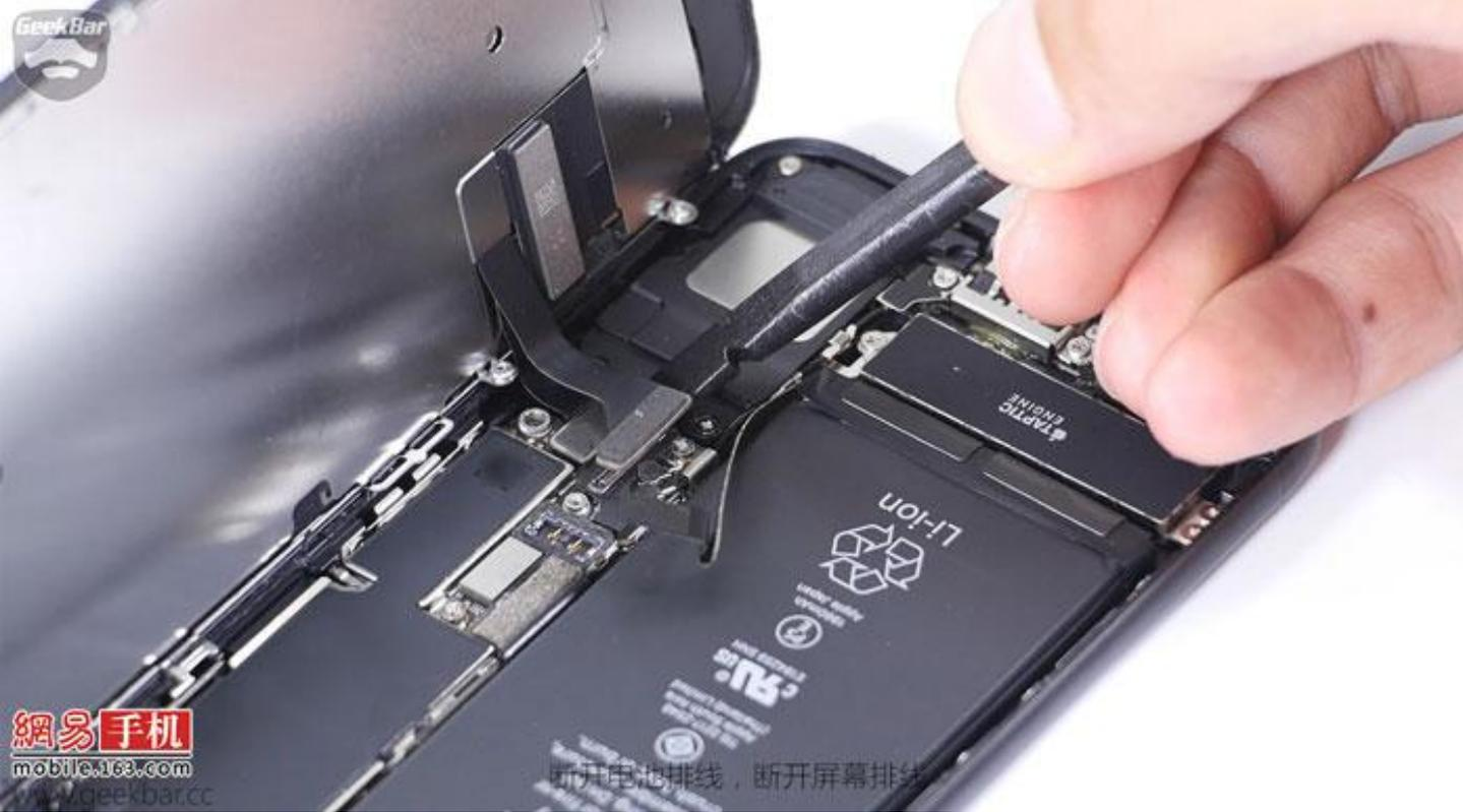
断开电池排线，断开屏幕排线
