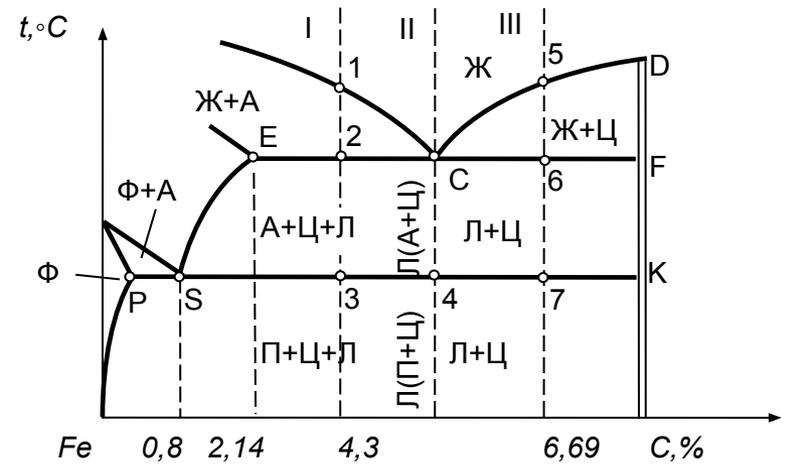
Часть диаграммы состояния «Fe – Fe<sub>3</sub>C» для высокоуглеродистых сплавов (чугунов)
