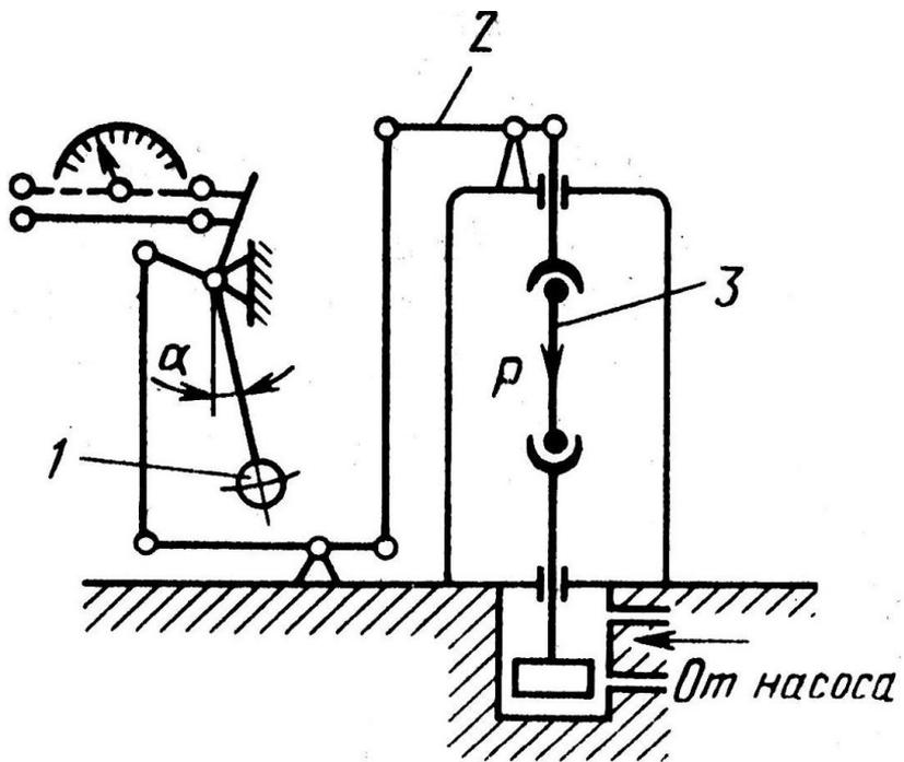
Схема разрывной машины с рычажно-маятниковым силоизмерителем
