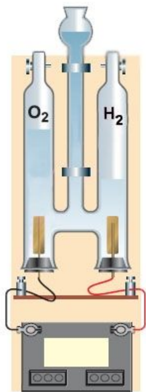
Рис. 78. Схема прибора для электролиза воды
