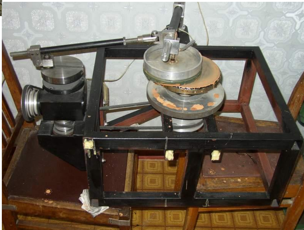
Станок для шлифовки и полировки оптических деталей диаметром блока до 100мм
