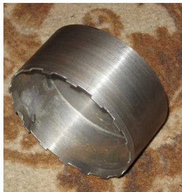
Стальная коронка с выфрезерованными пазами под алмазные сегменты
