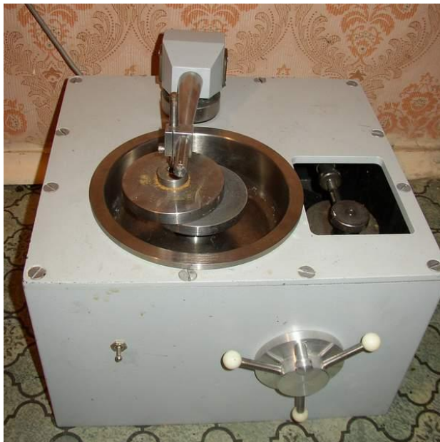
Станок для шлифовки и полировки оптических деталей диаметром блока до 100мм
