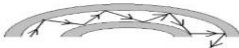
Распространение луча света в волноводе
