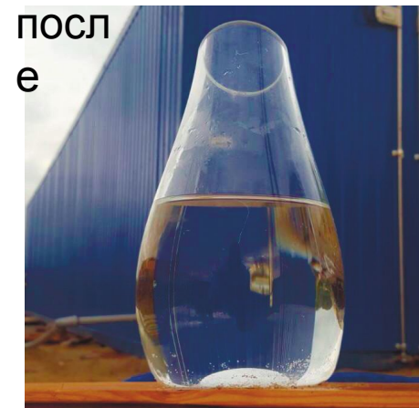
Степень очистки стока следующая: по жирам – до 98%, белки, органические соединения, яйцеглист, гельминты, цисты, биологические соединения, прочие биозагрязнения, макросоли – до 95%
