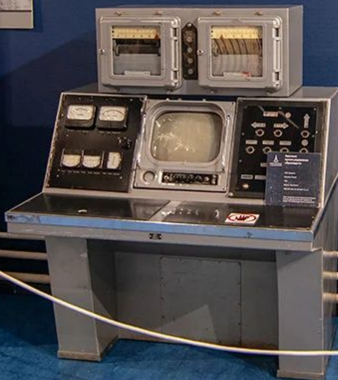
Фрагменты пульта управления «Луноходом-1». Справа — фрагмент колёсного шасси лунохода
