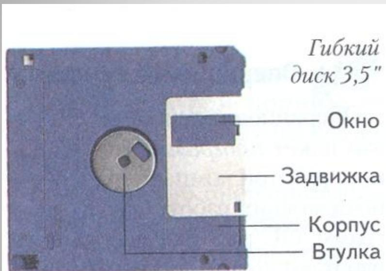
Гибкий диск вставляют в дисковод. При вращении диска считывающая головка считывает/записывает данные.
