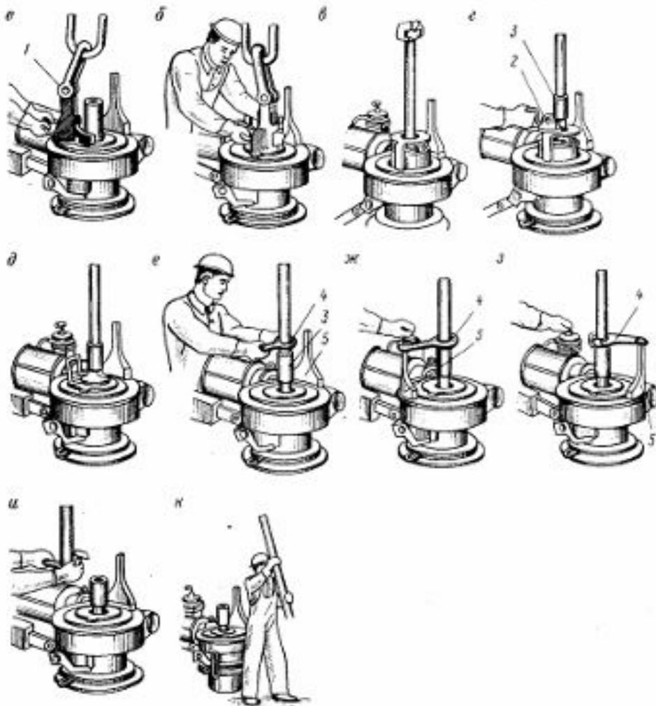
а), б) – захват трубы элеватором;
