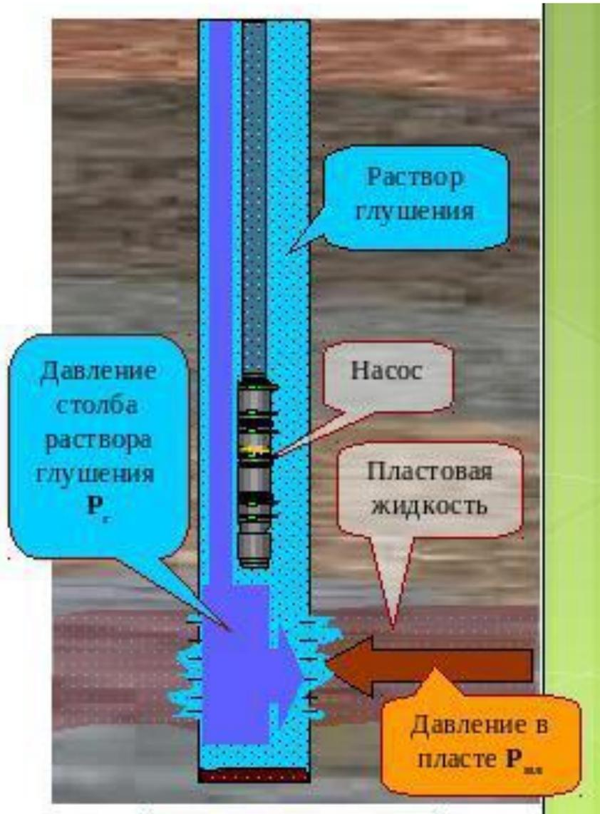
Глушение – это процесс создания противодействия на пласт эксплуатируемый или вскрываемый пласт с помощью задавочной жидкости в целях предупреждения газонефтеводопроявлений и открытого фонтанирования
