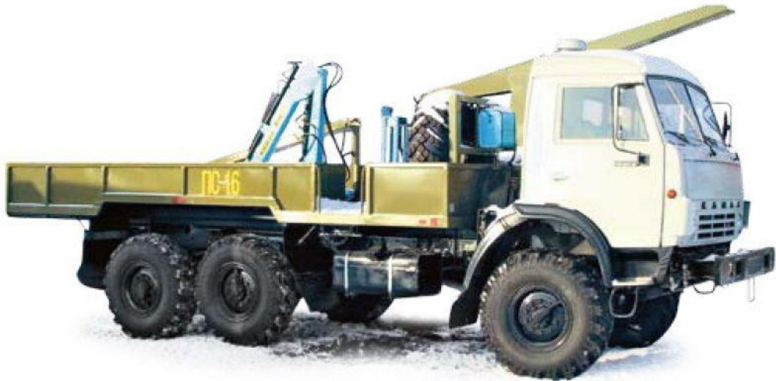
ПС–0,5К предназначен для механизированной погрузки, доставки на скважины и разгрузки длинномерного технологического оборудования (скважинных насосов, насосных штанг, насосно-компрессорных труб с покрытием и т. д.) без прицепных устройств при обеспечении его сохранности в процессе доставки
