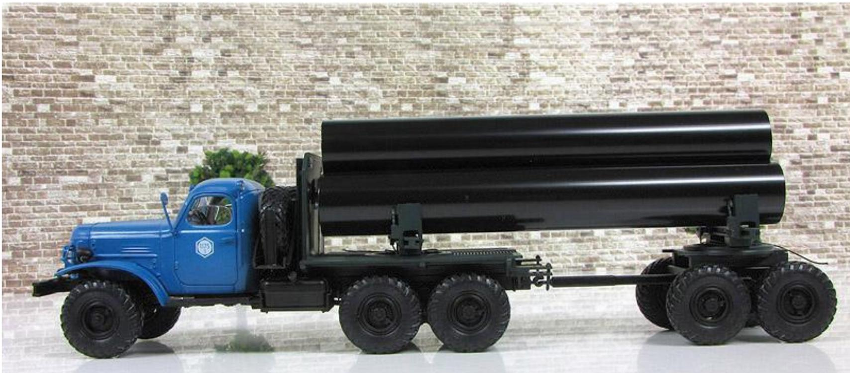
Трубовоз ТВЭ-6,5-131А, смонтированный на автомобиле-тягаче ЗИЛ-131А и прицепе-ропуске, предназначен для перевозки труб.
