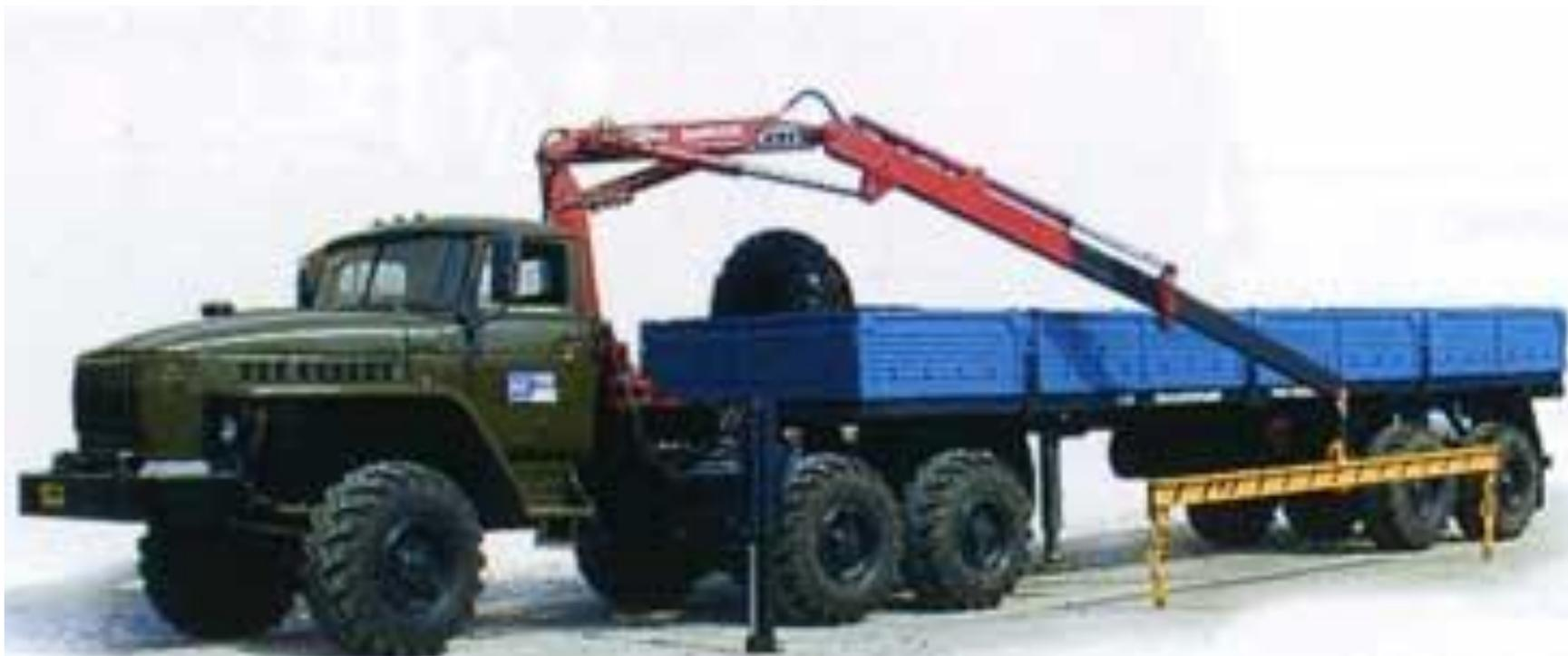
Агрегат предназначен для механизированной погрузки-разгрузки и перевозки различного длинномерного нефтепромыслового оборудования (насосно-компрессорные трубы, глубинно-насосные штанги и т.п.).
