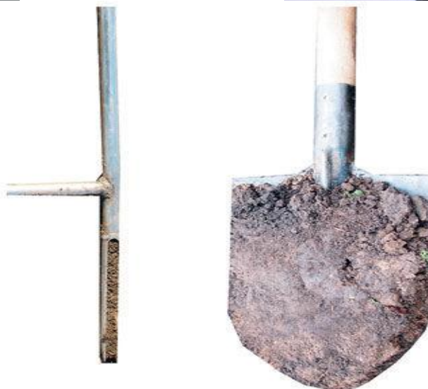
Рисунок 3. В отличие от цилиндрического бура, треугольная форма лопаты приводит к искажению результатов при отборе проб
