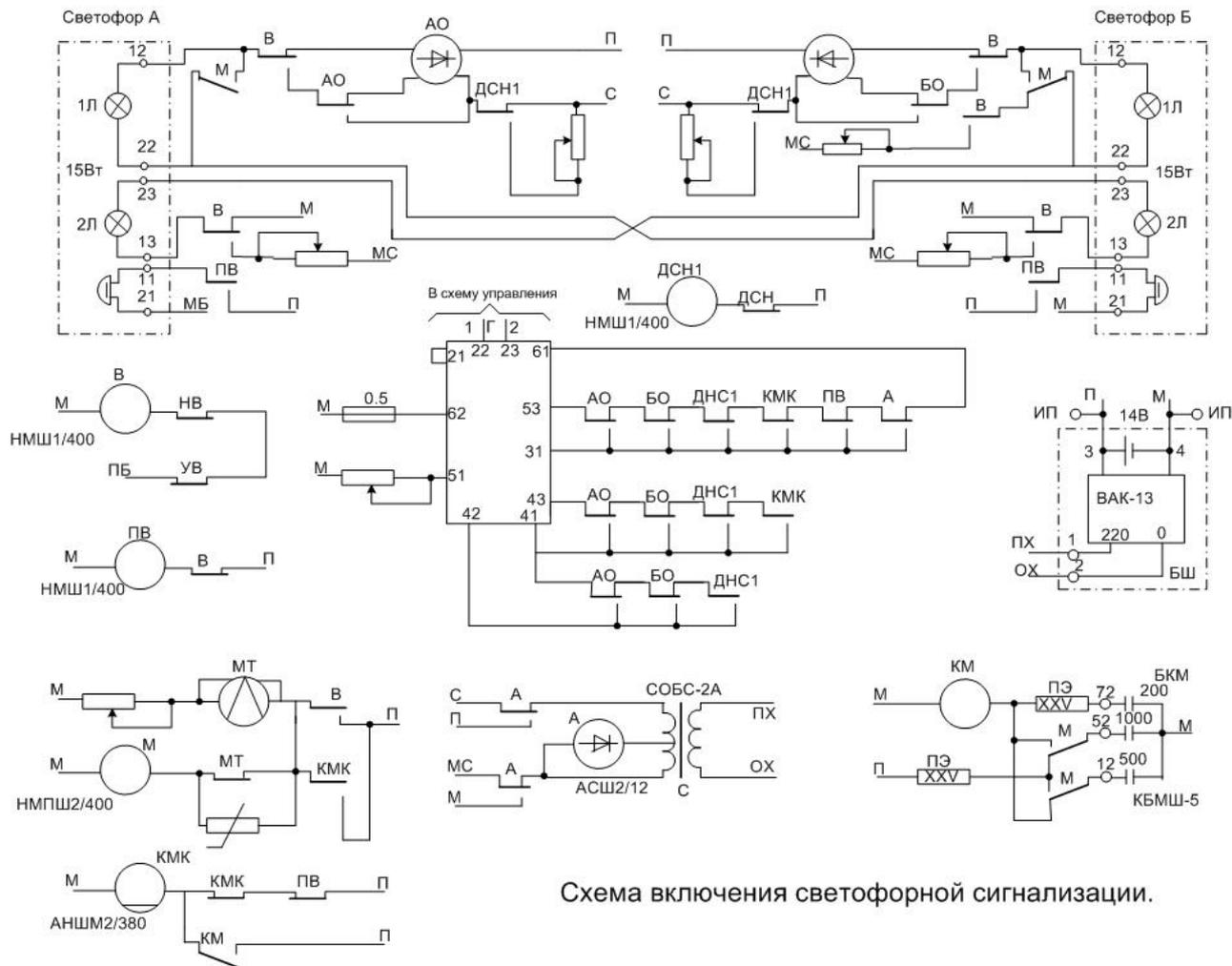
Схема включения светофорной сигнализации.
