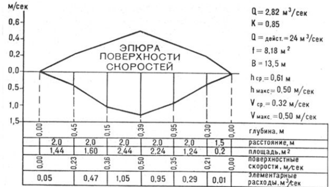
Рис. 13. Вычисление расхода воды графоаналитическим способом
