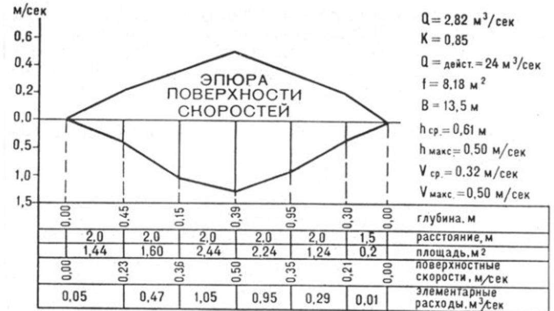
Рис. 13. Вычисление расхода воды графоаналитическим способом
