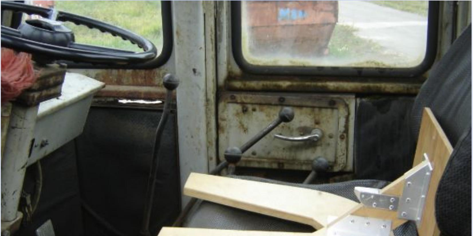
рычаг управления ковшом, рычаг управления стрелой, рычаг отключения заднего моста; рычаг диапазонов передач.
