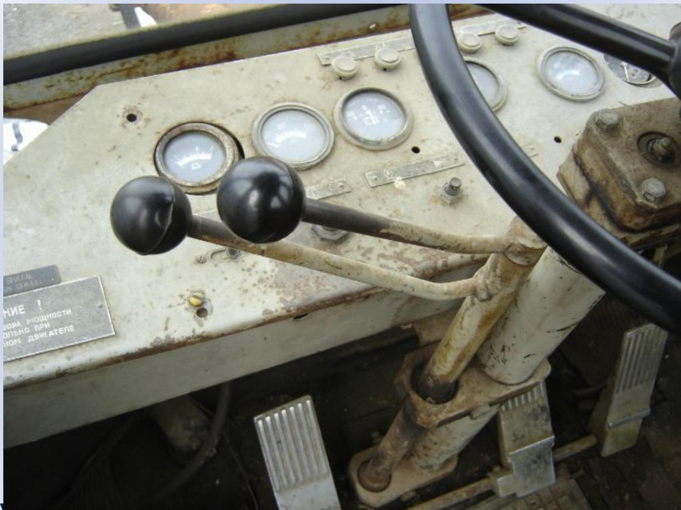
рулевое колесо, рычаг переключения режима КПП; рычаг реверса, педали тормоза и газа
