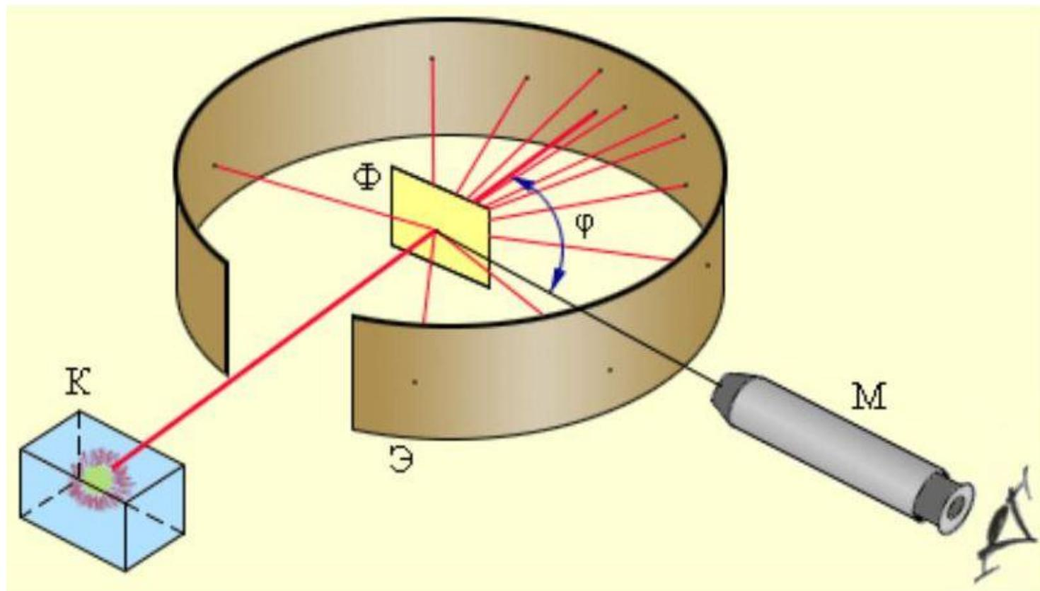
К – свинцовая коробка с радиоактивным образцом, являющаяся источником параллельного пучка  $\alpha$ -частиц
