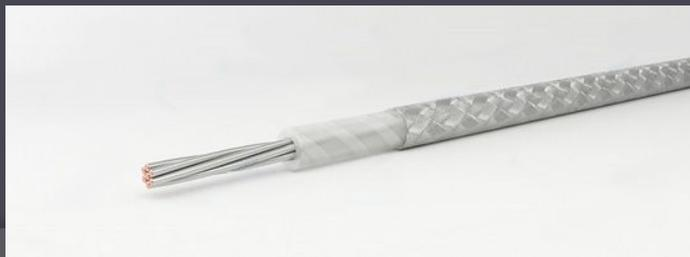
Токопроводящая жила скрученная из медных проволок с оболочкой в виде оплётки из лавсановой (полиэфирной) нити, покрытая кремнийорганическим лаком.
