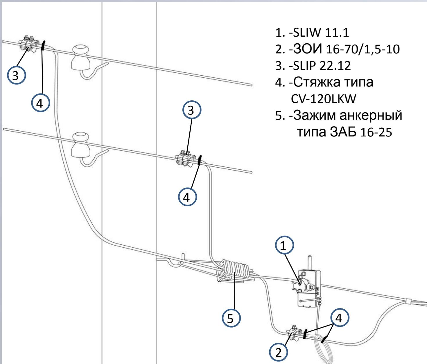
Схема монтажа счетчика РИМ 109.01, РИМ 189.01, -03 на ЛЭП выполненной самонесущим изолированным проводом, а ответвление к потребителю выполнено изолированным проводом
