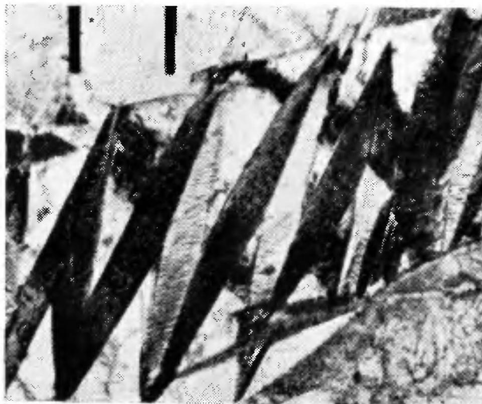
11В. Зигзагообразный мартенсит в стали с 24% Ni (0,5% C). ×12 000 (М. Г. Уэллс).
