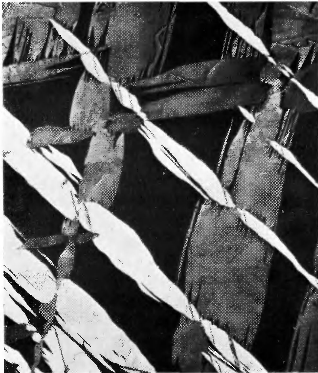
10Б. Двойниковые ламели в деформированном сплаве Bi — 5% Sb. \times 130 (У. С. Куунс и Э. Э. Ундервуд).
