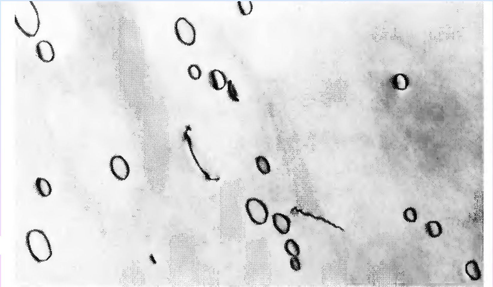
7A. Петли краевых дислокаций в кристалле окиси магния. \times 20\ 000 .
