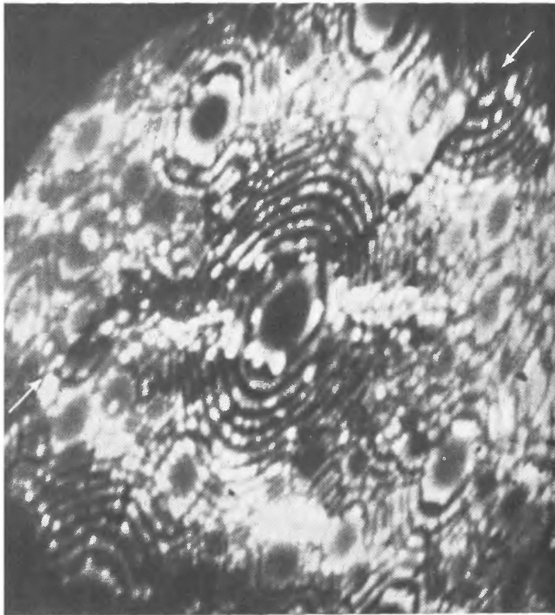
12В. Фотография (получена в ионном микроскопе) большеугловой границы между зернами (указана стрелкой) в сплаве W — 5% Re (Д. А. Смит).
