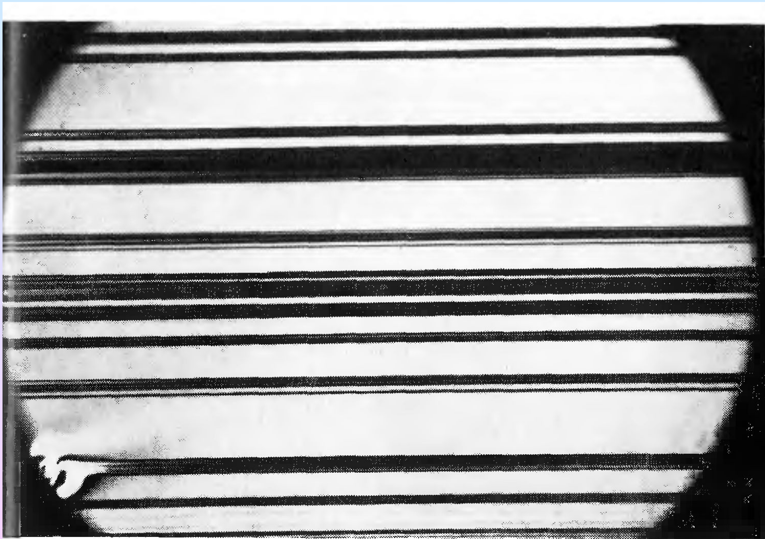
6А. Скопления линий скольжения в сплаве Cu — Ni. \times 600 (Р. А. Фоксалл).
