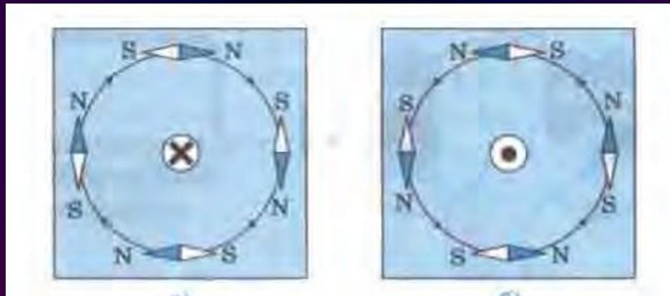
Из этого опыта следует, что направление линий магнитного поля тока зависит от направления тока в проводнике.
