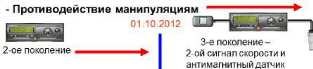
Тахографы, которые устанавливаются на автомобиль после 01.10.2012, должны иметь второй независимый источник сигнала движения и быть подключены к антимагнитному датчику.
