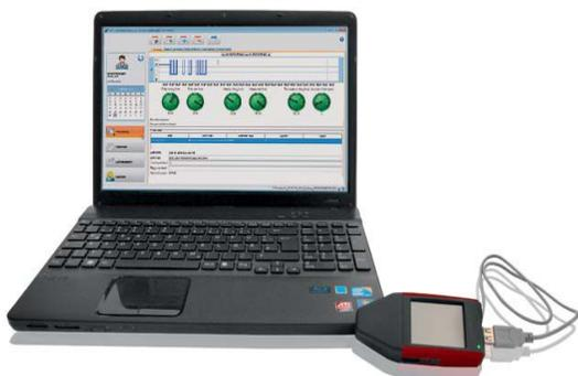
TIS-Compact® DLKPro дает возможность одновременного просмотра и обработки 5 автомобилей и 10 водителей, делает отметку о считывании данных, весит менее 50 грамм и легко помещается в кармане. Поскольку ему не требуется электропитание, TIS-Compact® DLKPro всегда готов к работе.
