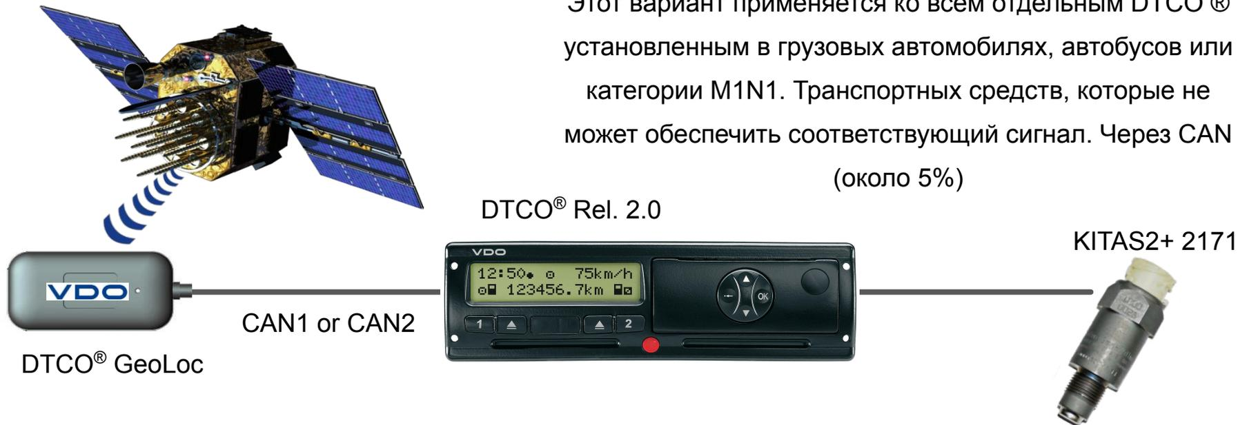
DTCO® GEOLOC может быть установлен на приборной панели, например. Для оптимального приема он должен быть установлен как можно ближе. На ветровое стекло насколько ЭТО ВОЗМОЖНО.
