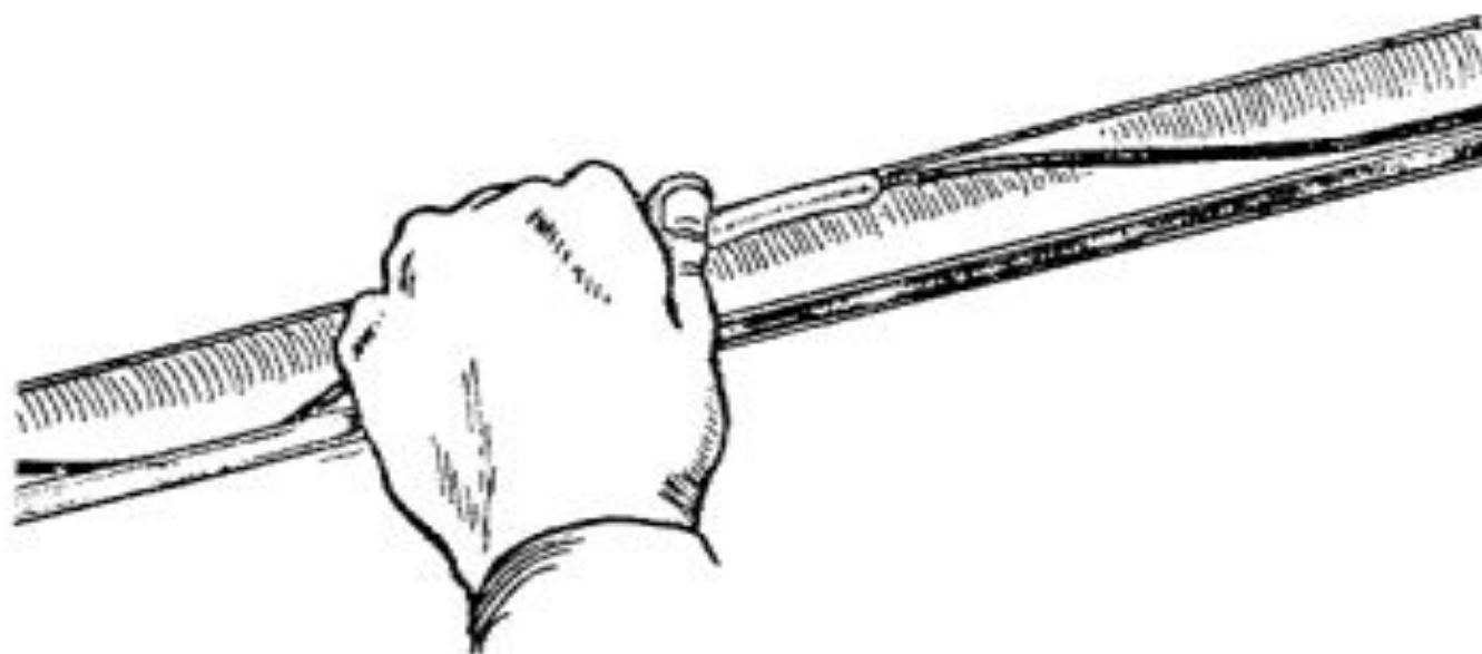
Изолирование спайки стального троса полиэтиленовой гильзой
