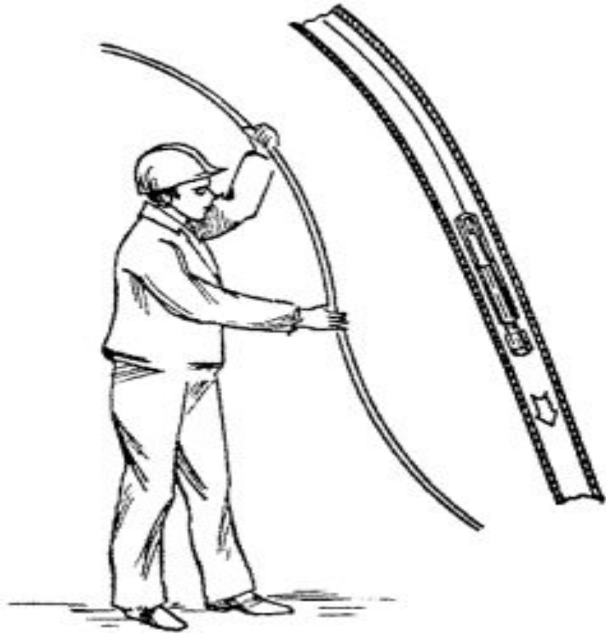
Заготовка полиэтиленовой трубы капроновым шнуром.
