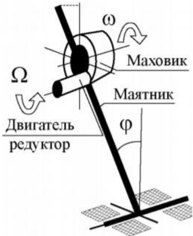
Кинематическая схема маятника: 1 — маятник; 2 — ось маятника; 3 — маховик; 4 — ось маховика; 5 — электродвигатель
