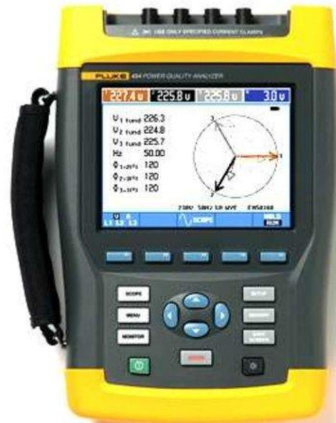
Fluke-434, Fluke-435 - анализаторы качества электроэнергии для трехфазной сети
