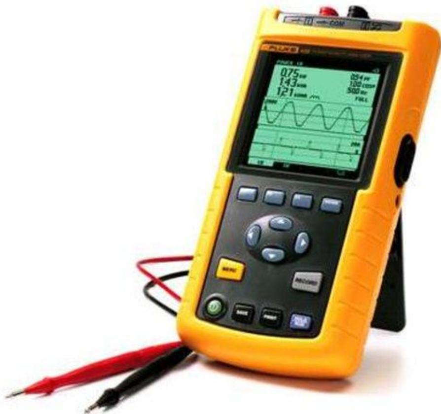
Fluke-43B - анализатор качества электроэнергии для однофазной сети
