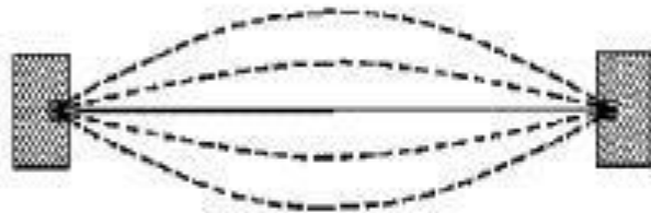
Рис. 2. Колебания струны, закреплённой на обоих
