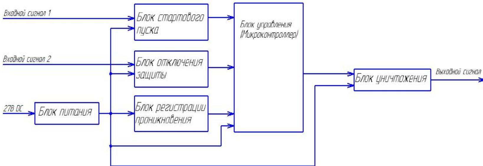
Рисунок 2 – Схема блока системы защиты структурная
