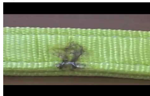
Тело стропа порезано под воздействием острой грани груза. На снимке - след от двутавра с острыми краями
