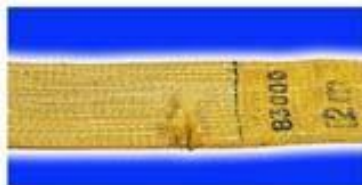
Повреждение главного шва
