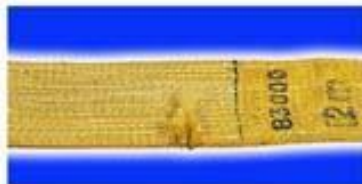
Повреждение главного шва
