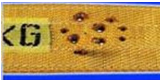
Более 10% поперечного сечения повреждено
