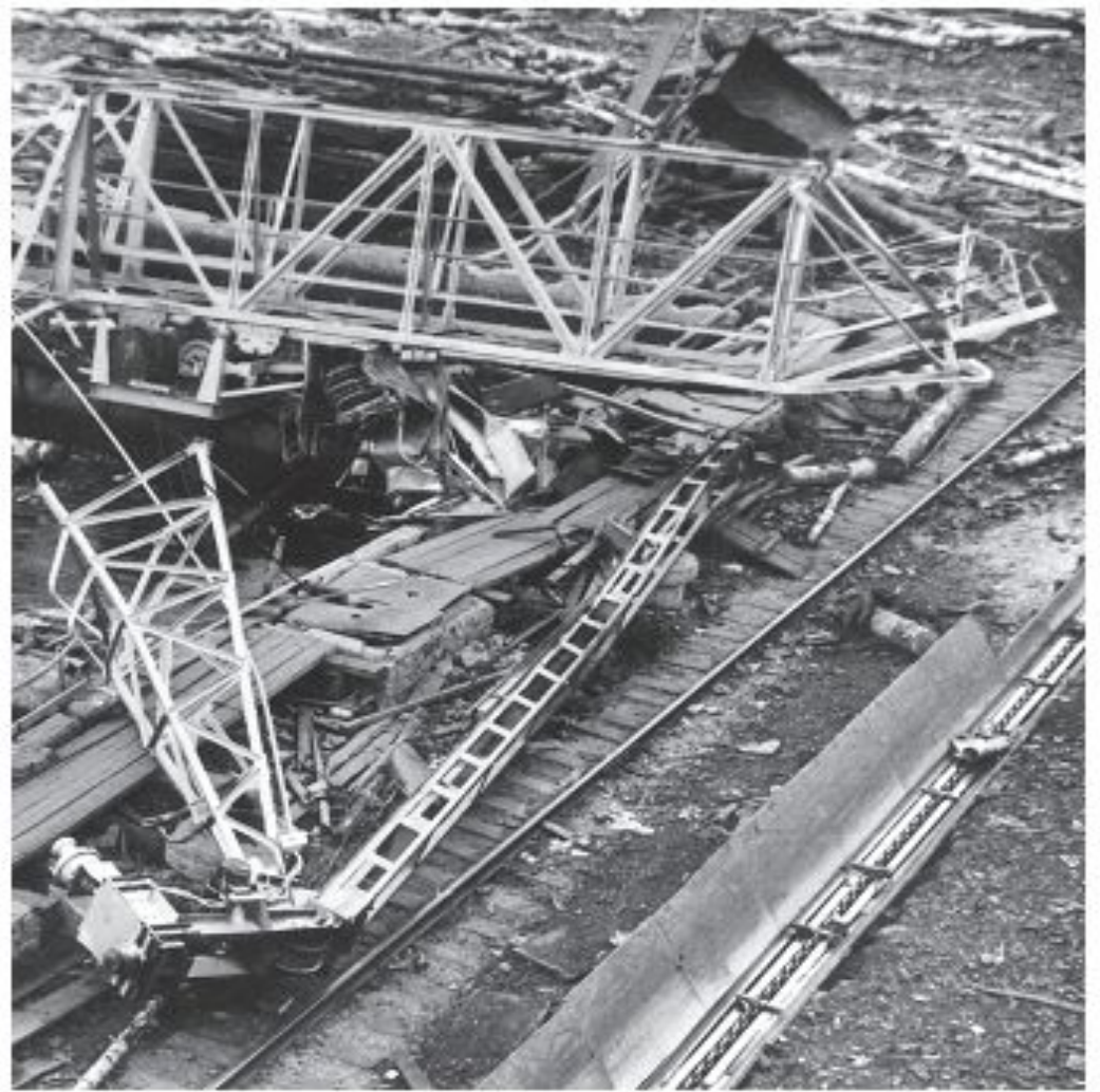
Рис. 11. Место аварии козлового крана ККС-10-32
