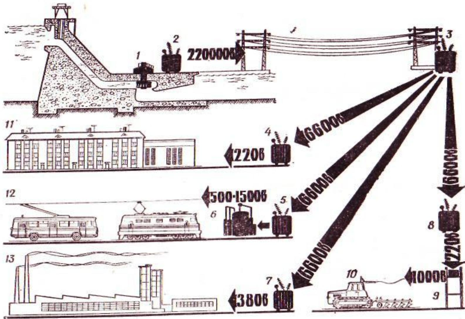
Рис. III-19. Схема передачи и распределения электроэнергии от электростанции к потребителям:
