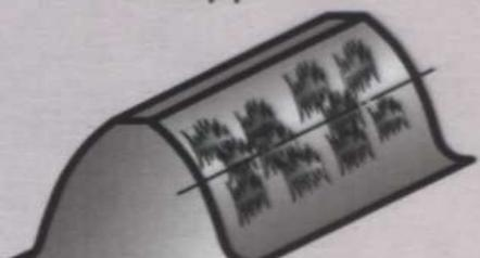
При высокой удельной нагрузке происходит разрыв масляной пленки, нагрев и схватывание сопряженных поверхностей с образованием микротрещин и следов задира в направлении скольжения зубьев.
