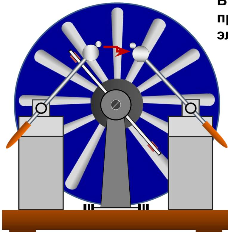
В **электрофорной машине** происходит превращение механической энергии в электрическую.
