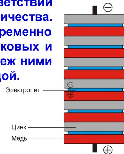
К гальваническим источникам тока относятся **аккумуляторы** (аккумулятор – накопитель).
