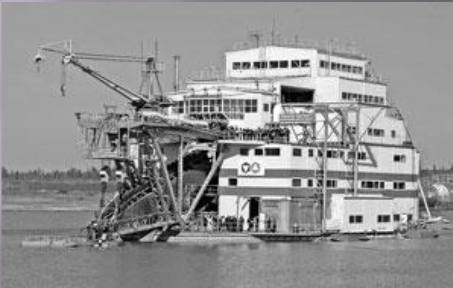
Дра́га — комплексно-механизированный горно-обогажительный агрегат, работающий по принципу многоковшового цепного экскаватора, установленный на плавучую платформу.
