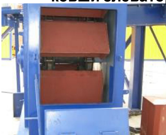
Износостойкие ковши элеватора
