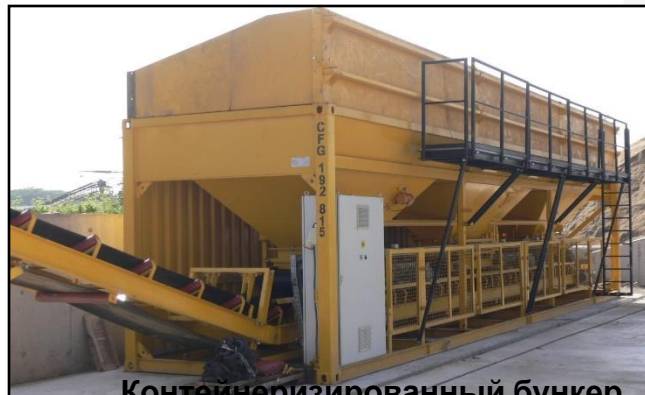
Контейнеризированный бункер холодных дозаторов
