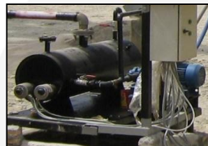
ТОПЛИВНЫЙ ЦИРКУЛЯЦИОННЫЙ НАСОС ДЛЯ ГОРЕЛКИ ТЯЖЕЛОГО ТОПЛИВА
