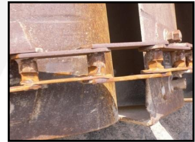
Изношенные боковые пластины боковой цепи
