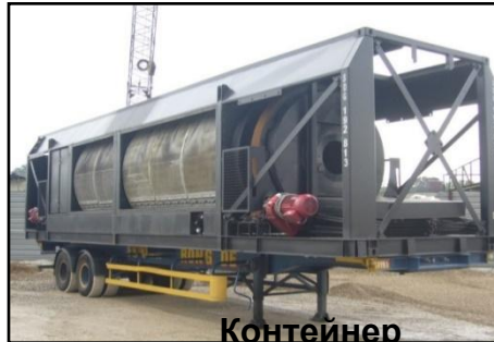
Контейнер просеивающего барабана
