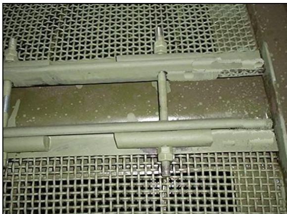
ЭКРАННОЕ СИТО СКРЕПЛЯЕТСЯ БОЛТАМИ НА ДРУГОМ КОНЦЕ
