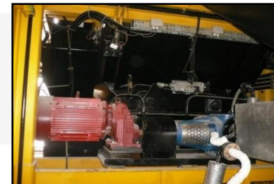
Битумный насос высокого давления
