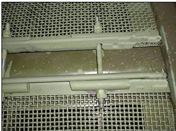
ЭКРАННОЕ СИТО СКРЕПЛЯЕТСЯ БОЛТАМИ НА ДРУГОМ КОНЦЕ
