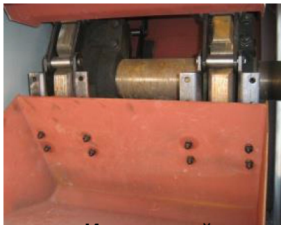
Износостойкие ковши элеватора
