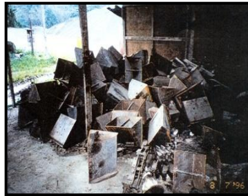
Замена изношенных ковшей
