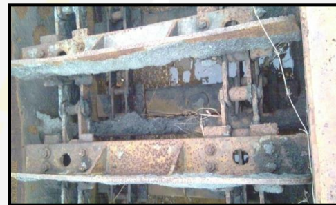
Изношенные ролики цепи
