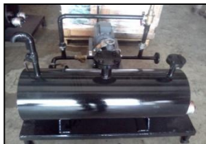
ПРЕДВАРИТЕЛЬНЫЙ ПОДОГРЕВАТЕЛЬ ТЯЖЕЛОГО МАСЛА
