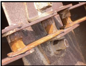
Изношенные боковые Пластины боковой цепи
