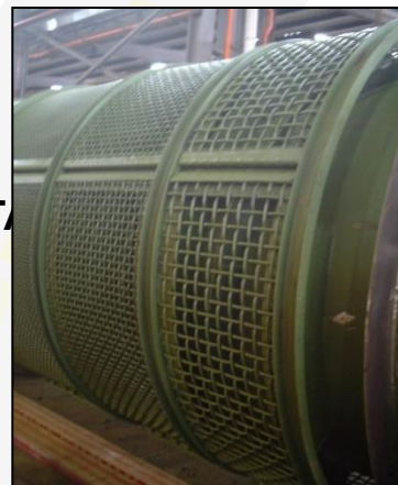
ЭКРАННОЕ СИТО ЗАКРЕПЛЕННОЕ НА ОДНОМ КОНЦЕ
