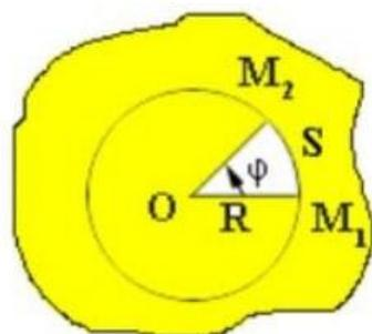
Действительно, путь, пройденный данной точкой за время  $\Delta t$ , равен  $\Delta S = R\Delta\varphi$  ( $\varphi$  в радианах). Отложив эту длину пути  $S$  вдоль дуги окружности радиуса  $R$  от начального положения точки  $M_1$ , определим положение данной точки в момент времени  $t$ .
