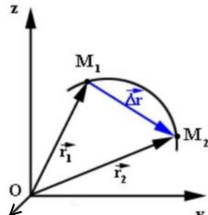
Скорость определяет быстроту движения и его направление в данный момент времени.
