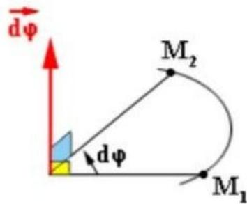
Чтобы фиксировать эту плоскость, следует  $\overline{d\varphi}$  рассматривать как вектор, перпендикулярный этой плоскости (рис. 16). Его направление находится по правилу буравчика.
