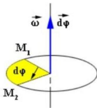
Введём величину, характеризующую быстроту изменения угла  $\Delta\varphi$  с течением времени. Эту величину назовём средней угловой скоростью  $\langle \overline{\omega} \rangle = \frac{\overline{\Delta\varphi}}{\Delta t}$ .
