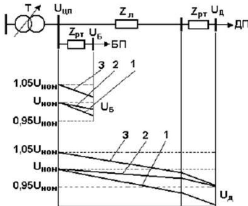
Схема сети и эшюры напряжений, поясняющие принцип встречного регулирования напряжения
