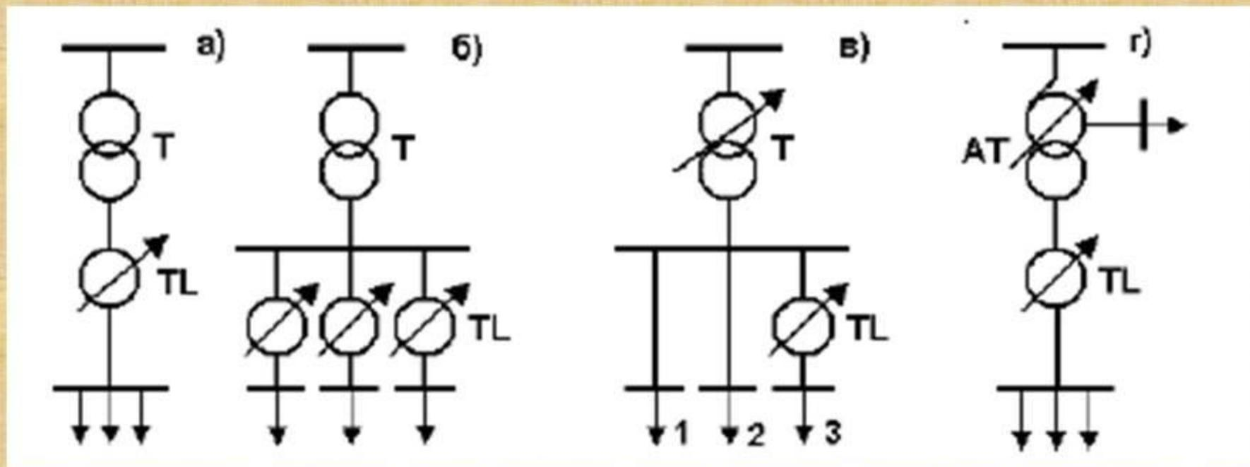
Принципиальные схемы включения линейных регулировочных трансформаторов
