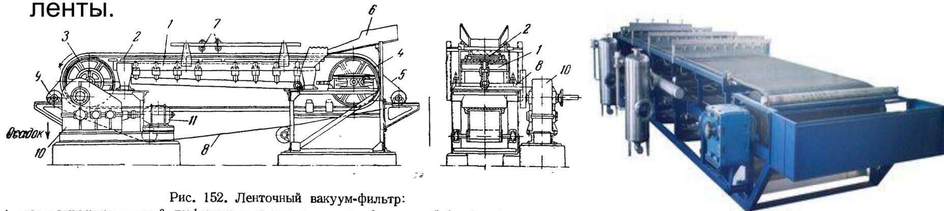
Рис. 152. Ленточный вакуум-фильтр:
