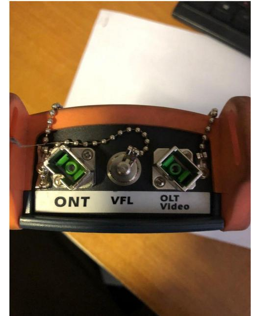
4. Обычным измерителем оптической мощности (ФОД или ИТ-09Р) мы сможем измерить только видеосигнал установив длину волны: 1550
