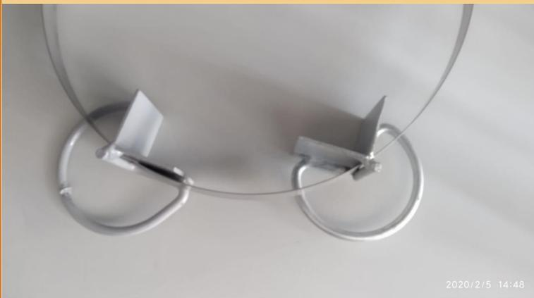
3. Берем инструмент для натяжки бандажной ленты и производим натяжку. Загибаем ленту при помощи машинки и отрезаем лишний кусок.
