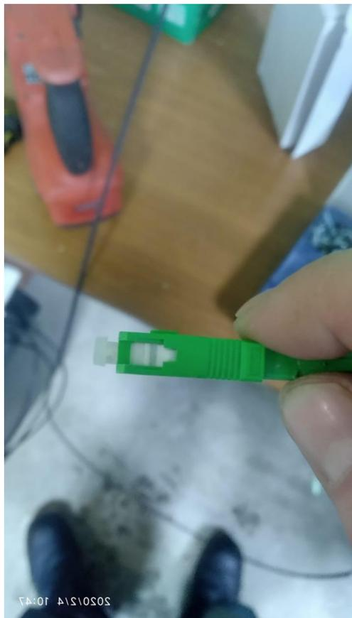
2. При установке «рубашки», обращаем внимание на внутреннюю форму «рубашки» и пигтейла, с верхней стороны края будут скошенные. Одеваем «рубашку» до щелчка. Если все сделали правильно, то она будет иметь свободный ход.
