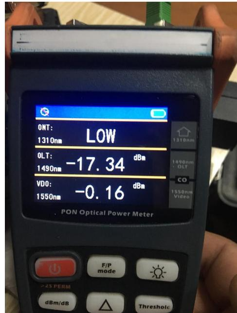
3. Для замера обратного сигнала необходимо подключить KIWI в разрыв с ONT
