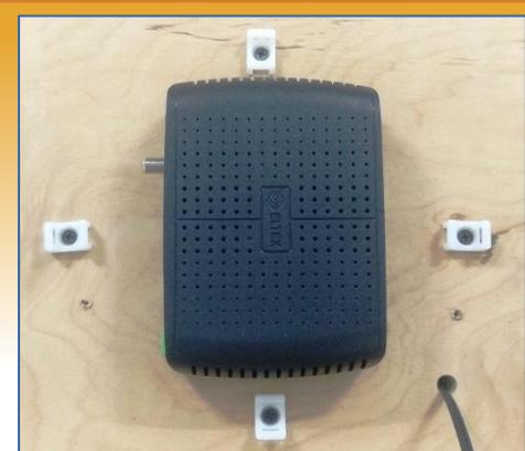
1) Размечаем места под крепления терминала. Если есть специальный шаблон, то используем его. Если шаблона нет, то можно использовать инструкцию в комплекте
