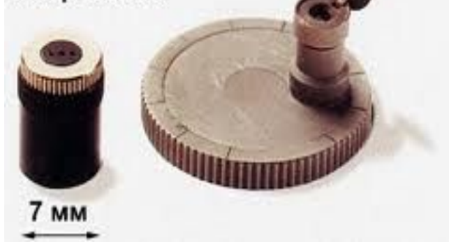
Специальная фотокамера Mk-IV и микроскоп ЦРУ для микроточек
