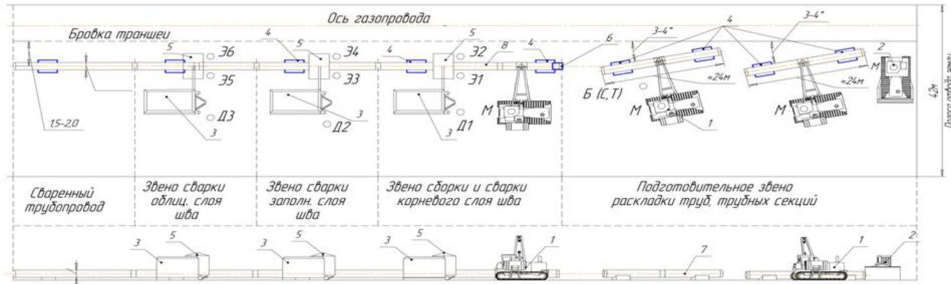
Рабочий персонал: М - машинисты; Б - бригадир; С - слесарь; Г - такелажник; Э - электросварщик; Д - машинист ДЭС.
