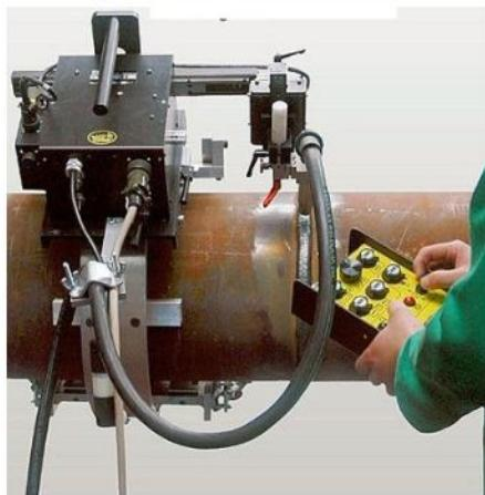
Общий вид сварочной головки
