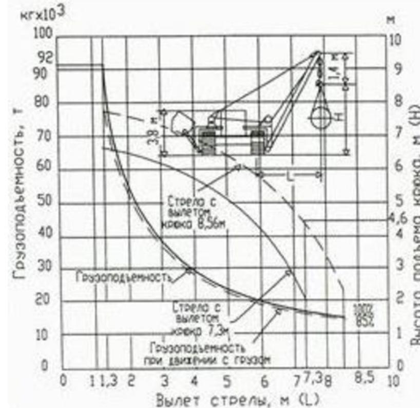
График грузоподъёмности трубоукладчика
