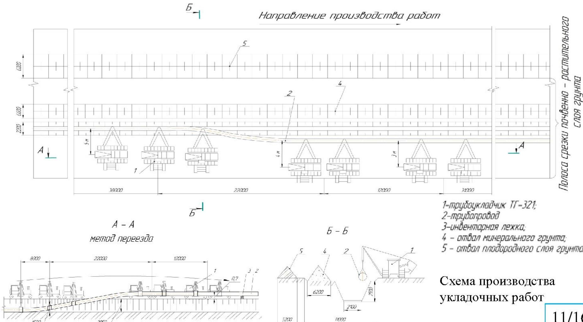
**РАССТОЯНИЯ (ПРОЛЁТЫ) МЕЖДУ ГРУППАМИ ТРУБОУКЛАДЧИКОВ (ПО ХОДУ УКЛАДКИ):**
