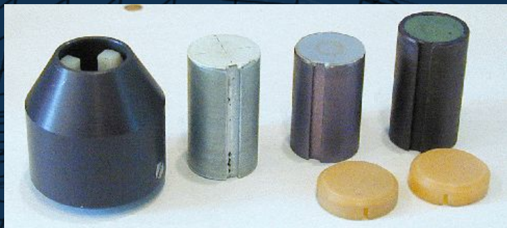
для центровки пуль и гильз диаметром до 9,5 мм
