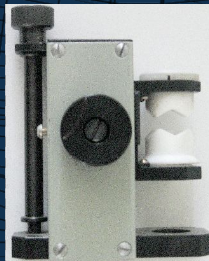
для сканирования дна гильзы
