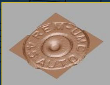
Трёхмерное изображение дна гильзы в предыдущих версиях АБИС Арсенал
