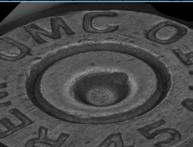
Трёхмерное изображение дна гильзы
