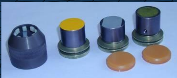
для центровки пуль и гильз диаметром более 9,5 мм
