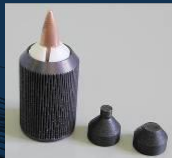
для центровки пуль с сильно деформированным доннышком
