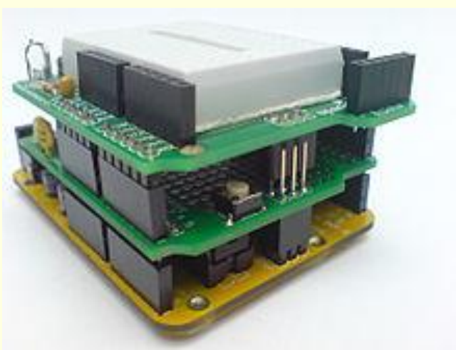
Стандартный конструктив Ардуино с платами расширения
