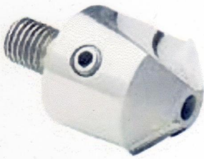
Рис. 19. Зенковка (а) и цековка (б) с рабочими элементами из ПСТМ.
