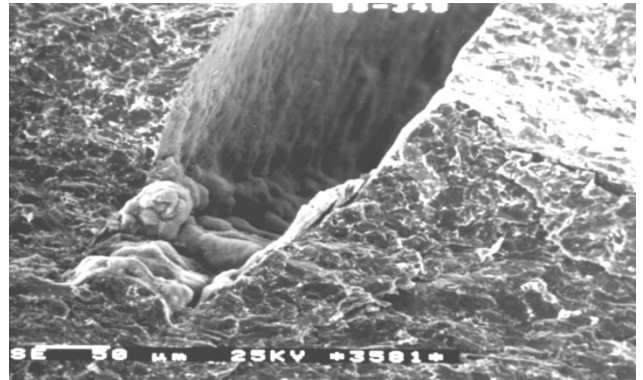
Канавки, прорезанные лазерным лучом, на пластине АТП: общий вид; единичная канавка.
