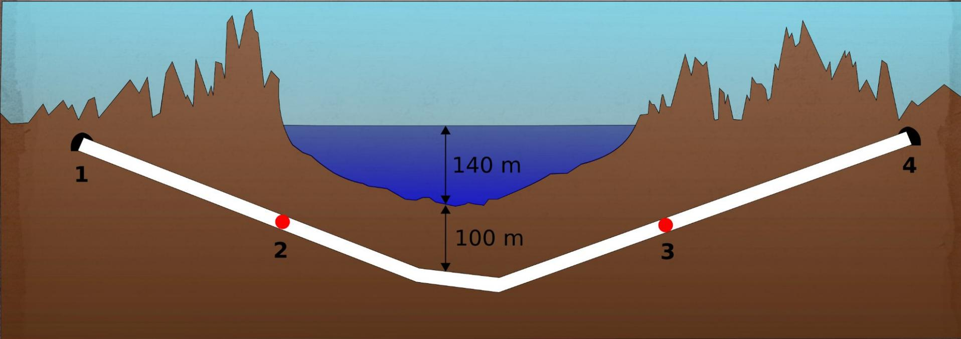
Dicke Beton-Wände des Tunnels 70 Zentimeter, aber das Wasser sickert ständig nach innen, eine vollständige Dichtheit nicht. Also im Tunnel arbeiten Pumpstationen, jede Minute entleerend auf der Oberfläche bis zu 16 Tonnen Wasser.
