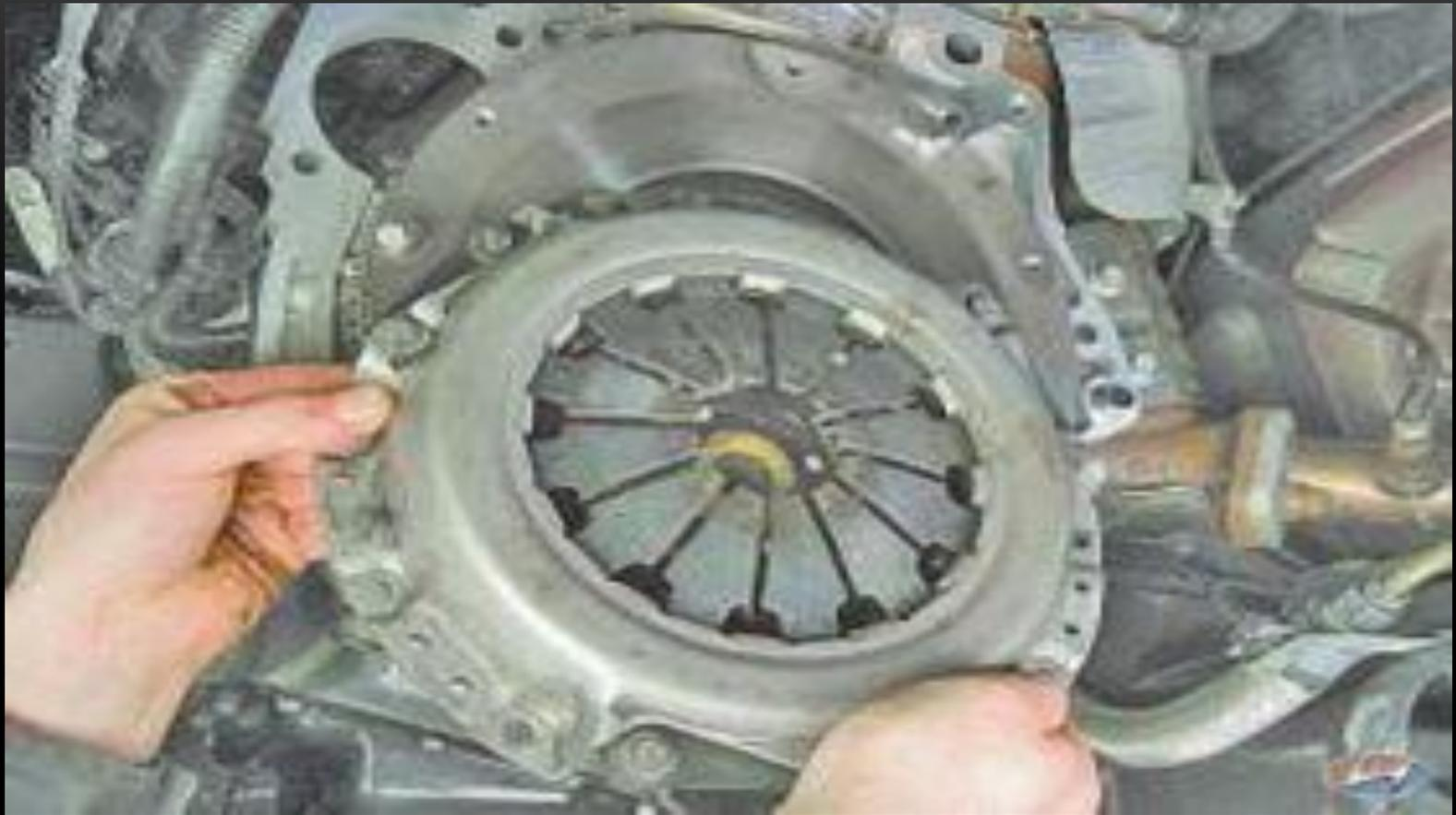
***РИСУНОК 11.4 СНЯТИЕ КОРЗИНЫ СЦЕПЛЕНИЯ***
