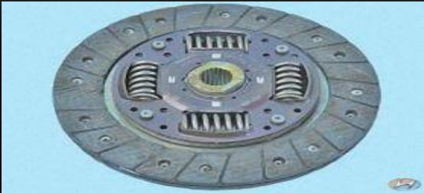
**Осмотрите ведомый диск сцепления. Трещины на деталях ведомого диска не допускаются.**
