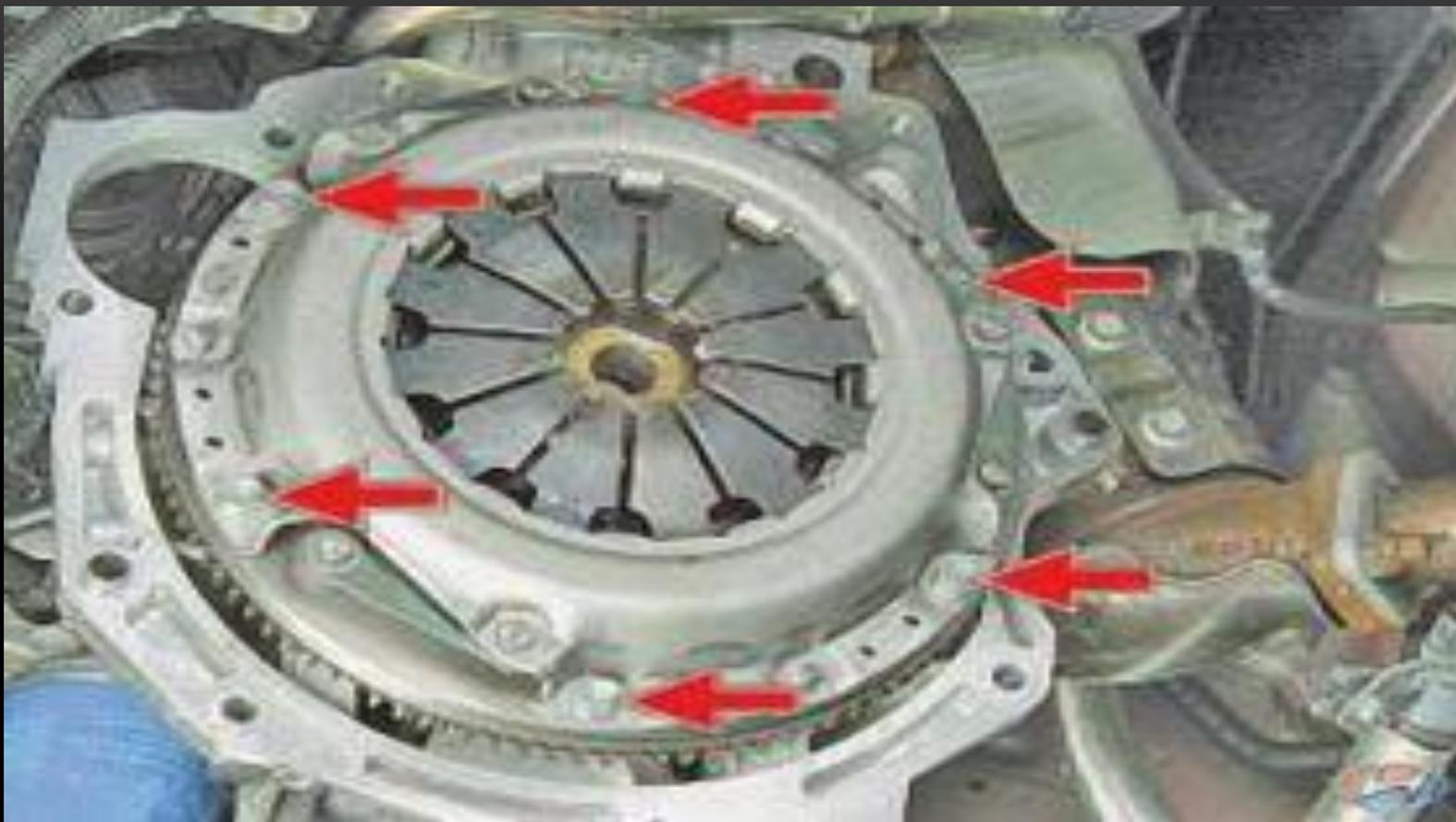
**УДЕРЖИВАЯ МАХОВИК МОНТАЖНОЙ ЛОПАТКОЙ (ИЛИ БОЛЬШОЙ ОТВЕРТКОЙ) ОТ ПРОВОРАЧИВАНИЯ, ВЫВЕРНИТЕ ШЕСТЬ БОЛТОВ КРЕПЛЕНИЯ КОЖУХА НАЖИМНОГО ДИСКА СЦЕПЛЕНИЯ К МАХОВИКУ. ЗАТЯЖКУ БОЛТОВ ОСЛАБЛЯЙТЕ РАВНОМЕРНО: КАЖДЫЙ БОЛТ ПО ДВА ОБОРОТА КЛЮЧА, ПЕРЕХОДЯ ОТ БОЛТА К БОЛТУ ПО ДИАМЕТРУ.**
