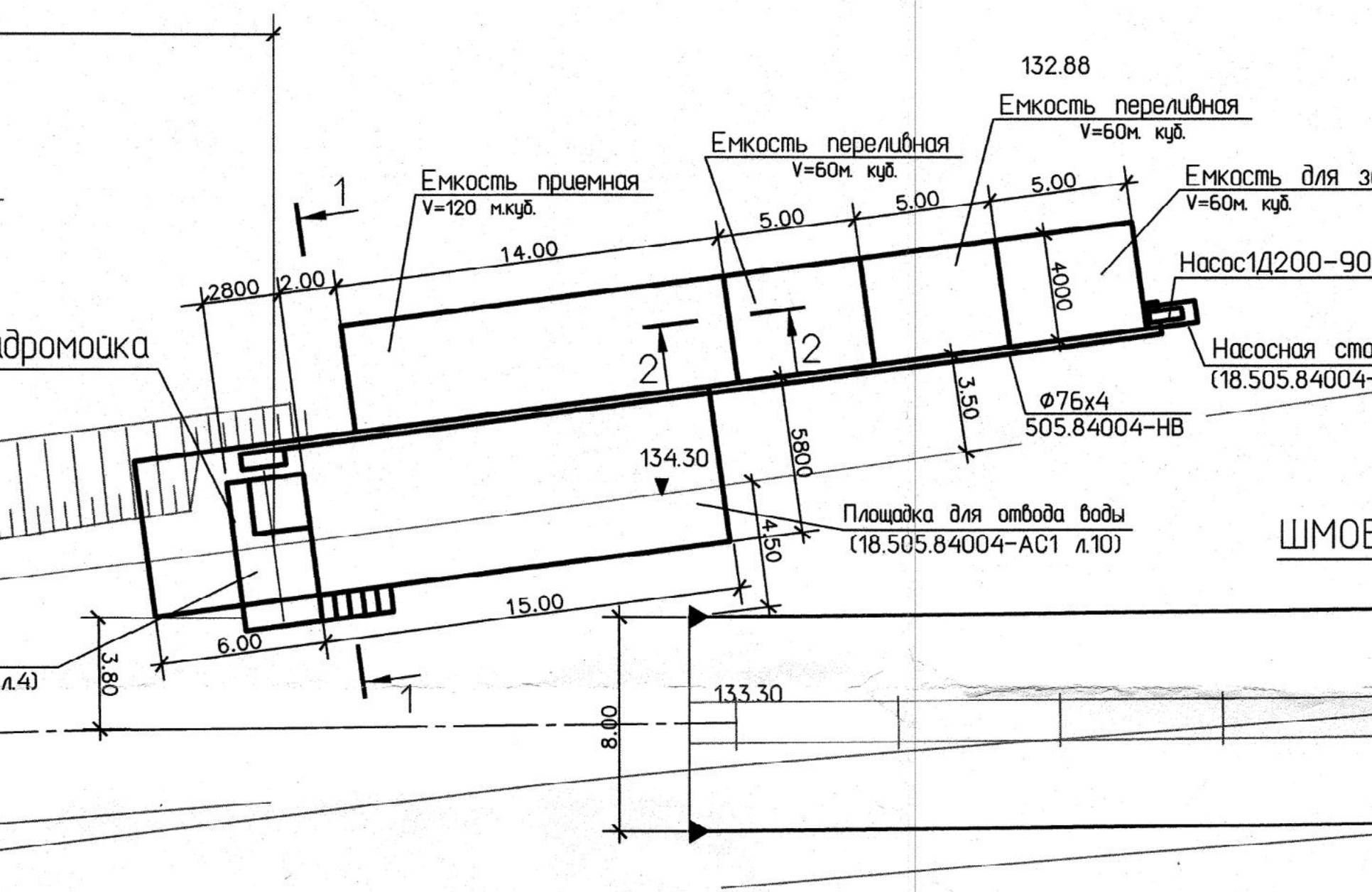
Рис. 2 – Технологическая схема резервуаров воды.
