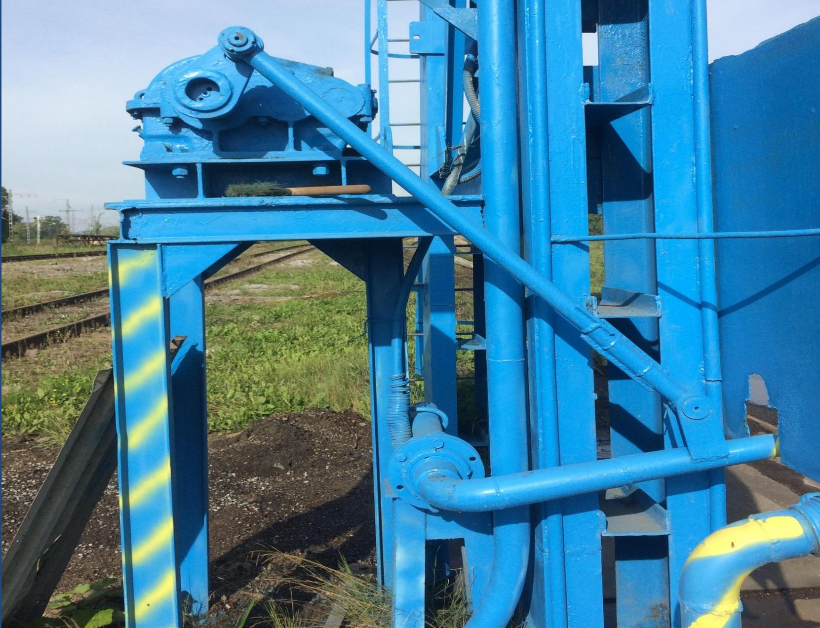
Рис. 3 – левый гидромонитор очистки вагонов.
