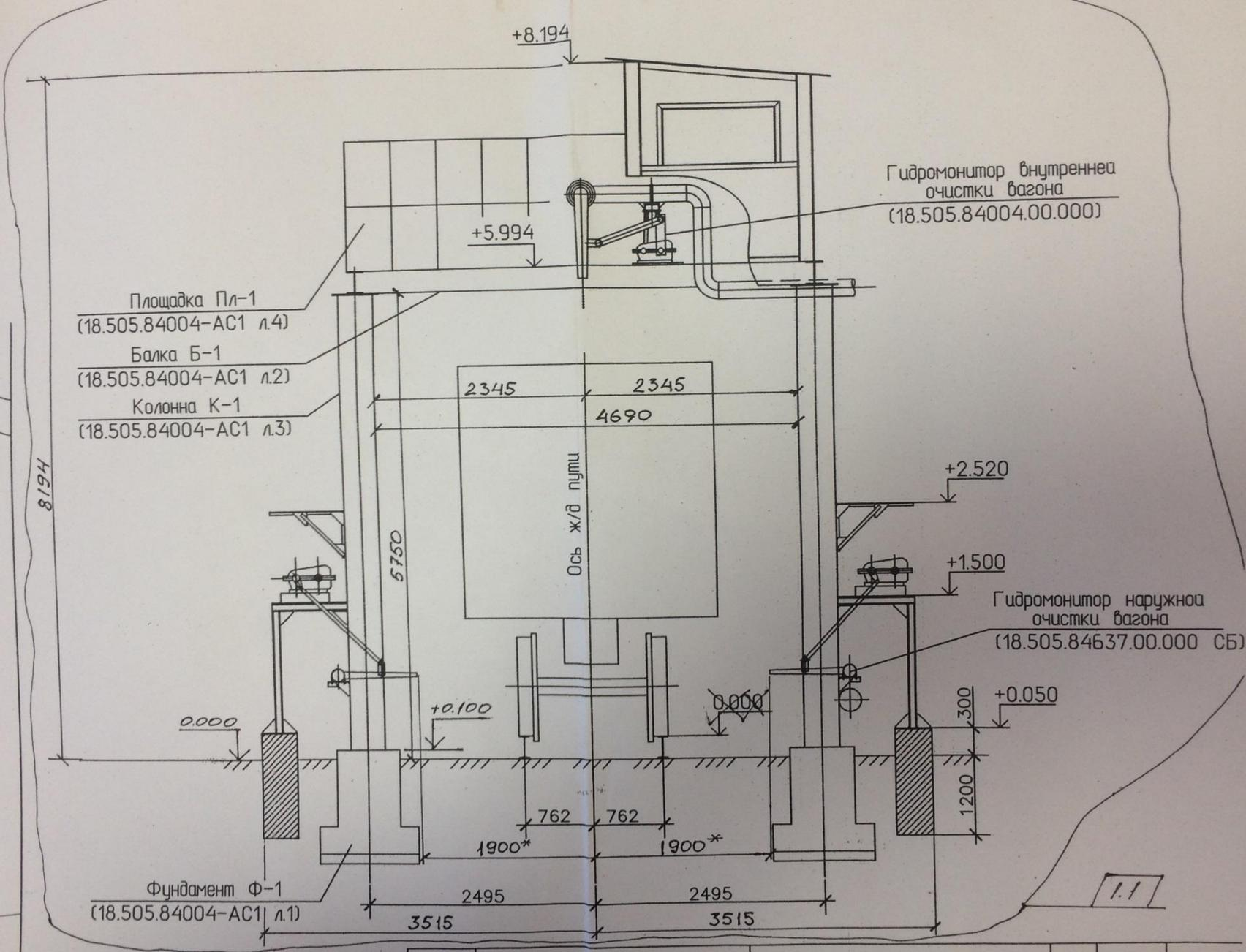
Рис. 1 – Устройство установки ГОВВ.
