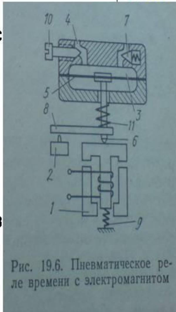
Рис. 19.6. Пневматическое реле времени с электромагнитом
