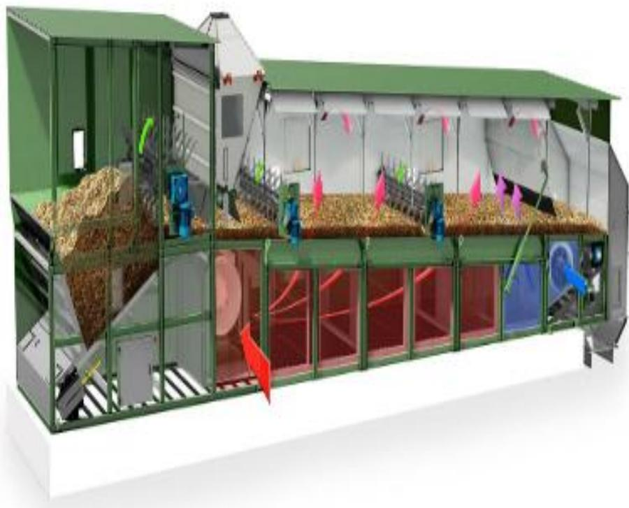
Источником теплоты в сушилках конвективного типа является горячий воздух, циркулирующий в полости камеры. Для нагрева воздуха в камере расположены специальные электрические нагревательные элементы.
